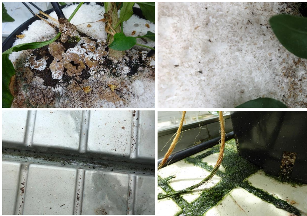
Abbildung 45: Pilze, Insekten und Algenbildung machen Lyocell unbrauchbar für die Verwendung in der erdelosen Kulturführung; Bild links unten: Drainrinne in Variante mit Kokos, Bild rechts unten: Drainrinne in Variante mit Lyocell
